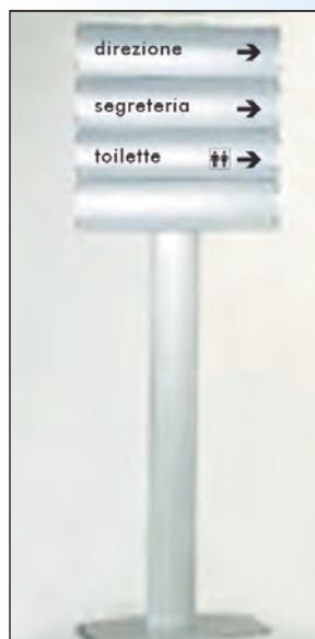
La colonna, concepita per uso in ambienti interni, costituisce il supporto per i listelli informativi, è alta 1800 mm ed è realizzata con un profilo ovale in alluminio anodizzato argento (larghezza 150 mm) fissato ad una base in ferro della misura di 540x320 mm di spessore 10 mm, ricoperta da un foglio in alluminio. Nella foto accanto è rappresentata la colonna completa di listelli informativi (vedi descrizione relativa al listello informativo).
