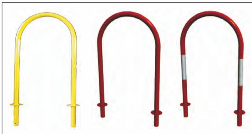
ARCHETTO PARAPEDONALE ABBATTIBILE in ferro verniciato a forno di colore GIALLO. Con foro per lucchetto (non incluso) ALTEZZA mm 520 - LARGHEZZA mm 480. PESO kg 2,8
